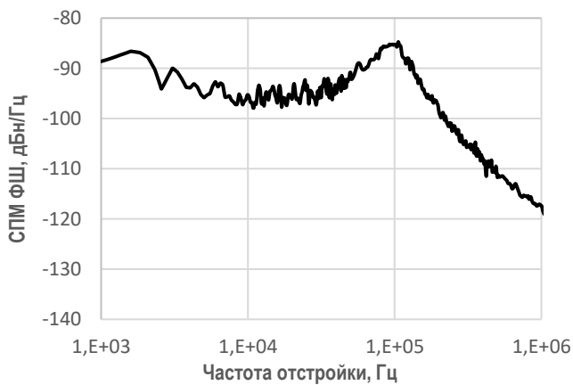
Рисунок 12 – Фазовый шум на выходе OUT2 синтезатора ( U_p = 3,3 В, дробный режим, F_{rf} = 12200 МГц, F_{ref} = 100 МГц)
