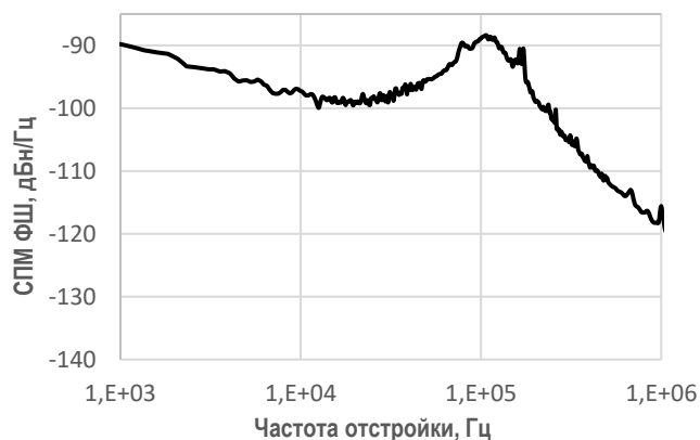
Рисунок 9 – Фазовый шум на выходе OUT2 синтезатора ( U_p = 3,3 В, целочисленный режим, F_{rf} = 9 ГГц, F_{ref} = 100 МГц)
