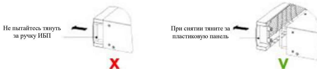
Рисунок 5 Снятие передней панели
